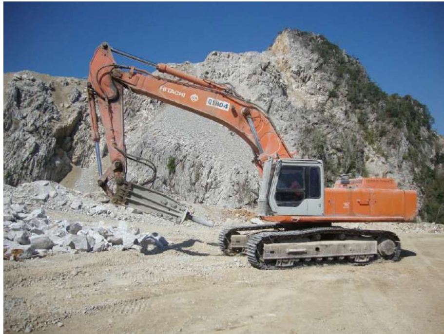
รูปที่ 2-9: รถแบ็คโฮรื้อตัดหัวกระแทกไฮดรอลิก
